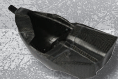
CASSA FILTRO IN CARBONIO disponibile per moto 4 tempi. CARBON FILTER CASE for 4 stroke motorcycles.
